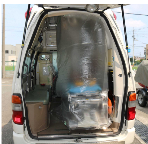
救急車内ビニール養生例
